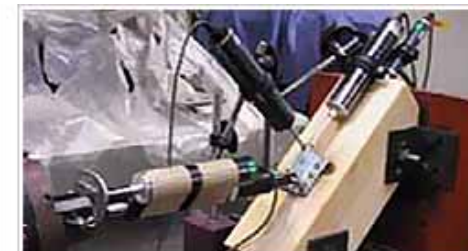
ダンパーを介して加力実験
